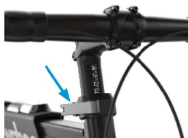
Réglage de la hauteur du cadre
