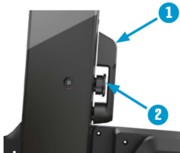
Ajuste de altura de la base
